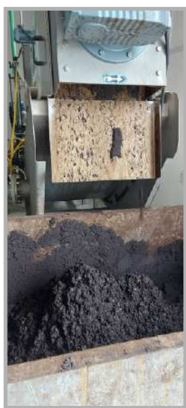
Slika 3. Pužni dehidrator, proizvođač: ATT&AT d.o.o.
